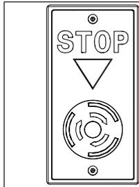
L'actionnement du bouton d'arrêt d'urgence entraîne l'arrêt immédiat du tourniquet et sa mise hors tension et le tourniquet peut être tourné à la main.
