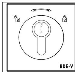
L'interrupteur à clé BDE-V (voir légende de l'équipement de sécurité et des éléments de commande) permet de verrouiller ou de déverrouiller la partie tournante.
