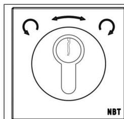
Si le fonctionnement de l'installation est empêché, par exemple par un capteur de sécurité défectueux, la partie tournante peut être mise sur la position souhaitée à l'aide de l'interrupteur à clé pour mode de secours (voir légende de l'équipement de sécurité et des éléments de commande) dans les deux sens de rotation.
