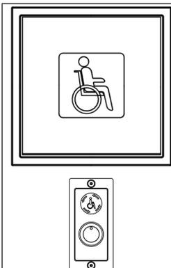
À l'actionnement du bouton pour handicapés dans les modes de service AUTOMATIQUE ou SENS UNIQUE, la partie tournante démarre et effectue à vitesse lente une rotation de 360°, ainsi qu'une rotation supplémentaire sur un segment.
